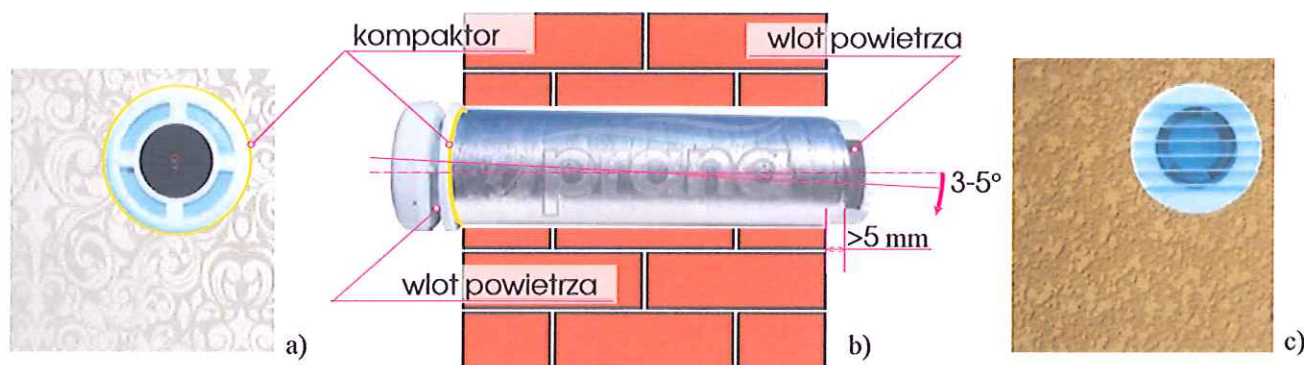
Rys 3. Schemat montowania układu wentylacji dolotowo-wyciągowej PRANA-150, PRANA-200 w ścianie: a) widok w domu; b) cięcie wzdłużne; c) widok z ulicy.
